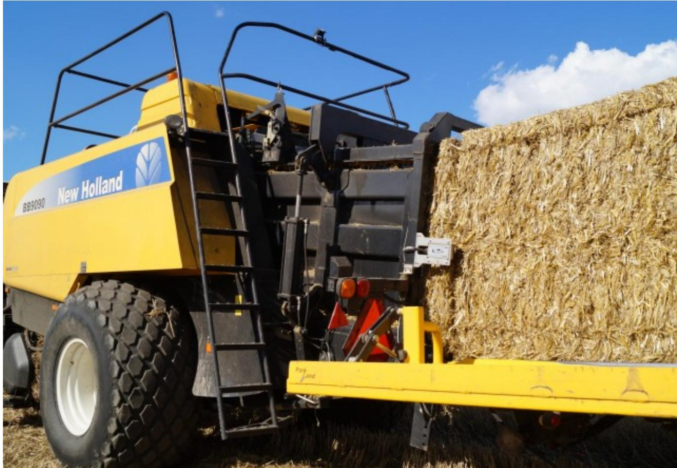
*Fugtmåleren fra DSE Test Solutions monteres bagest på eller i pressekanalen, og målerens to dele placeres parallelt over for hinanden.*
